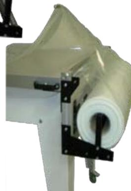
Réglage en profondeur du support de film
